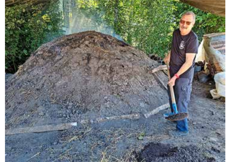
Wenn sich der Kohlenmeiler absenkt und Löcher entstehen, schüttet Henri Geissbühler sie mit Erde wieder zu. Bild Jean-Michel Wirtz
